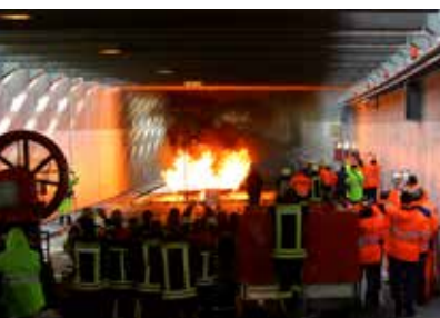
Brandversuch im Tunnel nach den Umbaumaßnahmen
